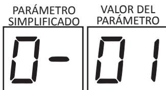
La centralita de mando llega configurada de fábrica en modo SIMPLIFICADO. Para el modo extendido de los parámetros véase el capítulo 11.
