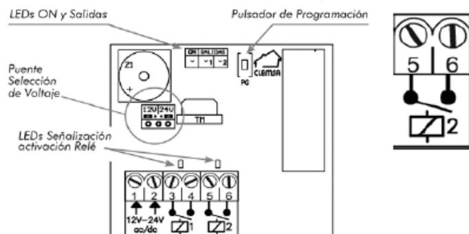
Conecte la entrada correspondiente de la puerta automática a esta salida de relé.
