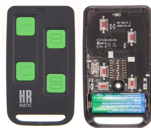
2.- Colocar los DIP-switch en la posición dependiendo del modelo de mando que tenemos.
