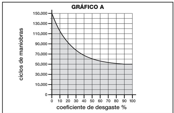
**Ejemplo de cálculo de la durabilidad de un motorreductor Walky con brazo entero (véanse la Tabla 14 y el Gráfico A):** - peso de la hoja: 100 Kg; - longitud de la hoja = 1,7 m (coeficiente de desgaste: 55%); - no presenta otros elementos de desgaste; Coeficiente de desgaste total = 55%; Durabilidad estimada = 55.000 ciclos de maniobras
