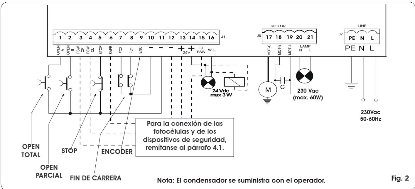
Para la conexión de las fotocélulas y de los dispositivos de seguridad, remítanse al párrafo 4.1.
