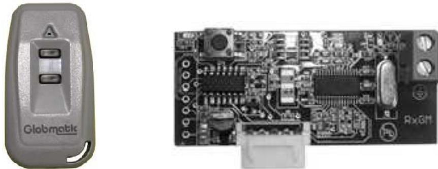
**Nota:** En el operador de techo Fénix el botón SW\_ RX de la placa OT100 es equivalente al botón P1 del receptor RXGM.
