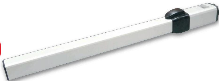
Operador hidráulico para cancelas batientes de una o dos hojas, uso residencial. Válvulas de seguridad antiplastamiento incorporadas. Desbloqueo rápido de emergencia. Carrera útil del vástago 270 mm. Diámetro del vástago 18 mm.
