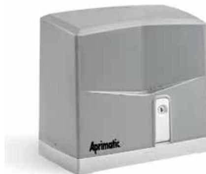
Operador a 24 Vcc para puerta corredera de hasta 700 kg. Uso intensivo. Incorpora el cuadro de maniobras, con sistema antiplastamiento para invertir la maniobra en caso de detección de obstáculos. Desbloqueo a llave personalizada en caso de falta de alimentación.
